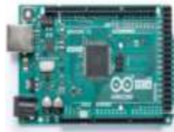
Gambar 1. Arduino Mega 2560 (Sumber: Kurniawan, 2019)
