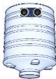
Gambar 15. Perancangan Penempatan Sensor Ultrasonik (Sumber: Dokumen Pribadi, 2021)
